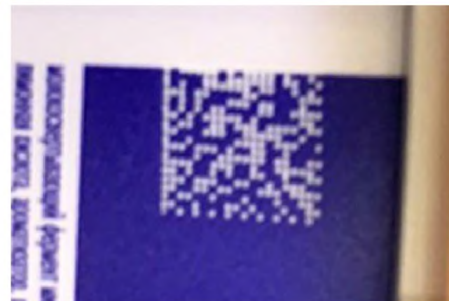
Отсутствие зоны покоя с одной из сторон
